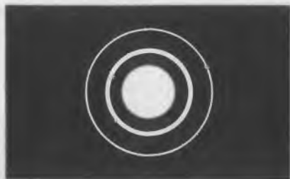
Рис. 2.10. Вид дифракционного изображения звезды.
