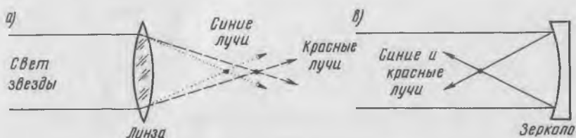
Рис. 2.13. Свет, сфокусированный (а) линзой и (б) зеркалом.
